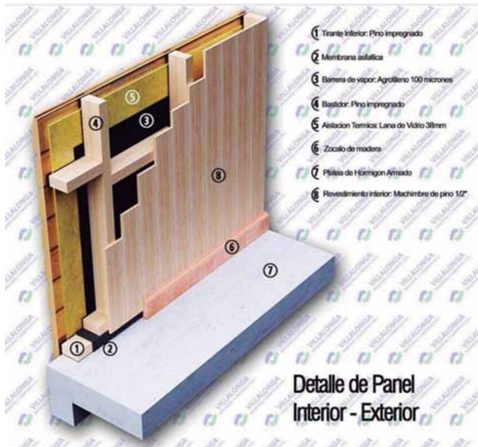
Detalle de los paneles utilizados, tanto para interior como para exterior. Referencias: 1) Tirante interior de pino impregnado; 2) Membrana asfáltica; 3) Barrera de vapor; 4) Bastidor de pino impregnado; 5) Aislación térmica (lana de vidrio de 38 milímetros); 6) Zócalo de madera; 7) Placa de hormigón armado; 8) Revestimiento interior en machimbre de pino impregnado.
