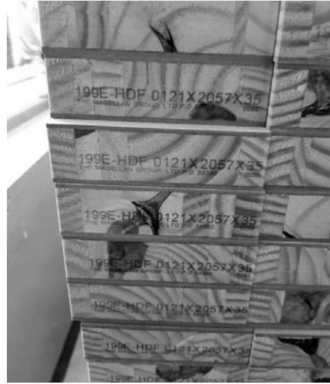
Door stiles o batientes de puertas con caras de HDF encoladas y laterales clear con finger joint. Para mercado final de puertas en Estados Unidos.
