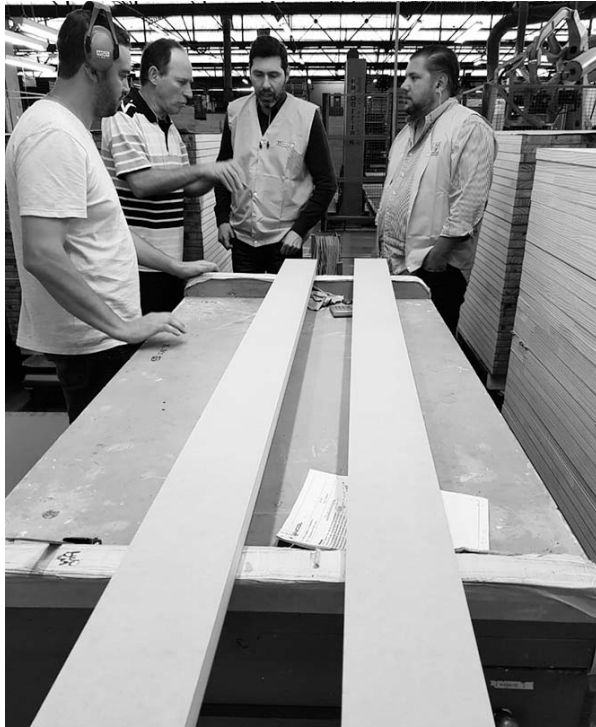
Door stiles o batientes de puertas con caras de HDF encoladas y laterales clear con finger joint. Para mercado final de puertas en Estados Unidos.
