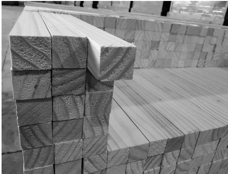
Producto: muntin cut stock precortado, para preparar molduras de puertas modelo tipo vidrio repartido. Mercados: Estados Unidos y Canadá.
